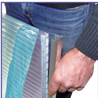
Montieren Sie dann an der Unterseite (Traufe) die Alu-U-Abschlussprofile mit Tropfnase nach unten. Die Schutzfolie wird dabei nur soweit entfernt wie es zur Befestigung nötig ist. Die gekennzeichneten Schutzfolien müssen nach außen gerichtet sein - UV-Schutz!
