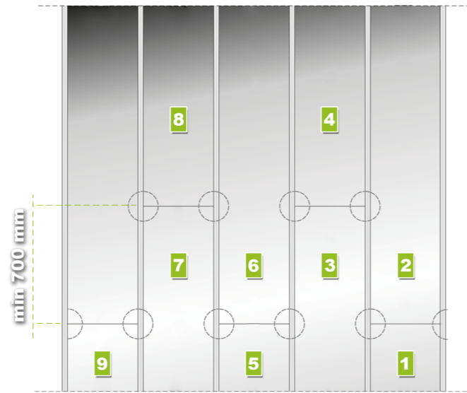
ABB. 19 Montage-Reihenfolge der Paneele – mit den Kreisen sind die Stellen gekennzeichnet, an denen die Schlösser ausgeschnitten werden
