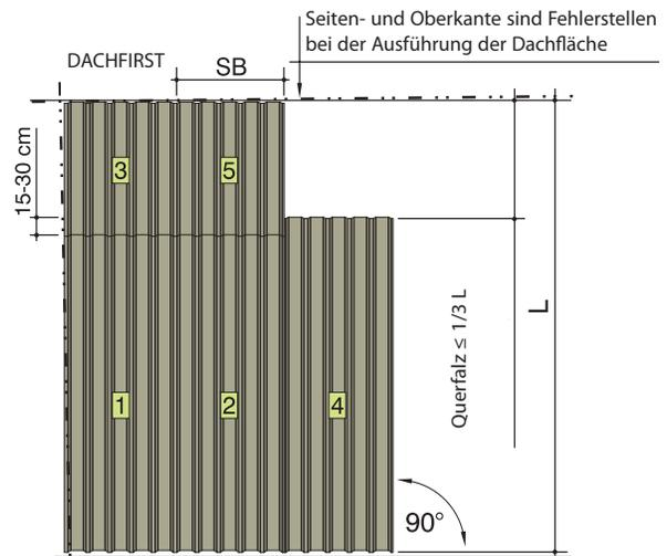
Der Dachfuß ist stets die Basis für die Montage von Trapezblechen
