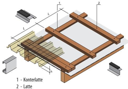
Die Lattenabstände „L“ werden in der Regel im technischen Plan angegeben. Sonst kann die nachstehende Formel oder die von der Fa. Pruszyński erstellten Tragkrafttabellen verwendet werden.
