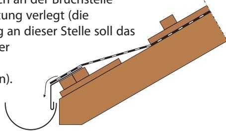
2. Die dampfdurchlässige Folie wird in die Rinne unter dem oberen Traufblech eingelassen.
