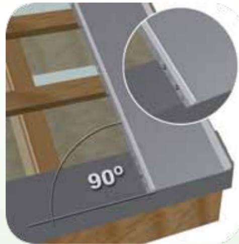
Abb. 10 Die Paneele müssen senkrecht zur Traufe verlegt und mit 2 Schrauben befestigt werden.
