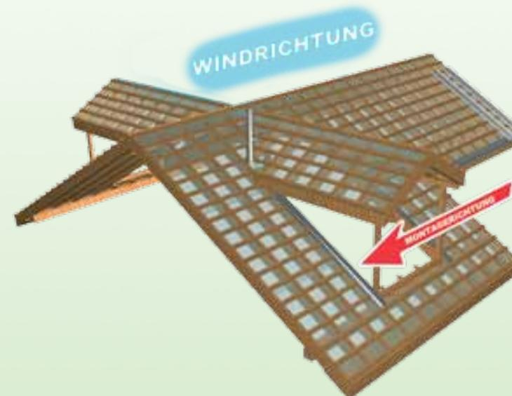
Abb. 8 Montagerichtung in entgegengesetzter Windrichtung
